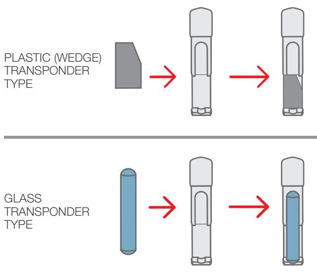
**Transponder holder fitting inside TE key** / Inserimento porta-transponder nella chiave TE / Einsetzen des Transponderhalters in den TE-Schlüssel / Insertion du porte-transpondeur dans la clé TE / Inserción del soporte del transponder en la llave TE / Inserção do suporte do transponder na chave TE.
